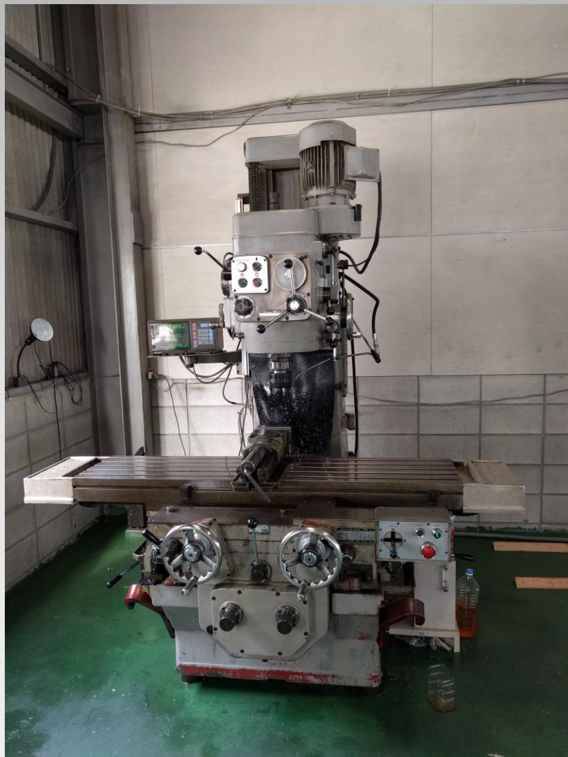
山崎技研 YZ-8C テーブルサイズ 1700×350 ストローク X1050、Y350、Z540
