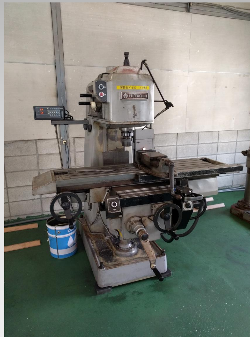
日立製作所 2MW-V テーブルサイズ 1350×310 ストローク X710、Y300、Z400
